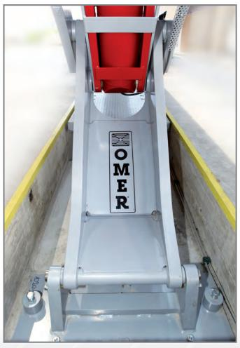
Viti di fissaggio a terra e viti di regolazione/livellamento della corsia Fixing screws on the ground and adjustment/runaway leveling screws
