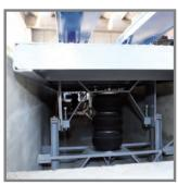
Pedanine automatiche coprifossa. Si installano per permettere il passaggio sotto le corsie del sollevatore all'utente sia a piedi che con i carrelli degli attrezzi.
