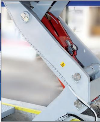
Perni passanti con boccole autolubrificanti e punti per l'ingrassaggio per garantire affidabilità e durata al minimo dei costi di manutenzione.
